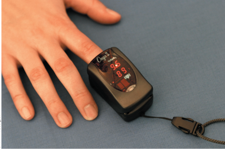
Mesure de la saturation en oxygène grâce à un capteur infrarouge.
