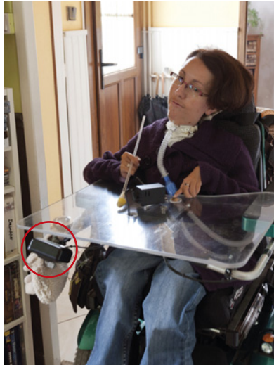
On peut piloter son installation de plusieurs endroits à condition de le prévoir. Ici, deux boîtiers de commande ont été installés, l'un sur le fauteuil et l'autre sur le lit.
